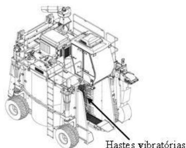
Colhedora de cana-de-açúcar: equipamento que permite a colheita de cana de modo uniforme gerando maior produtividade, por possuir sistema de corte de base capaz de cortar a cana-de-açúcar acompanhando o perfil do solo, reduzindo a quantidade de impurezas e palha no produto final. Possui um sistema de elevador que desloca a cana cortada até a unidade de transbordo.
