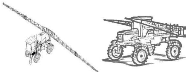
**Pulverizador tracionado:** implemento agrícola que, quando acoplado a um trator agrícola, pode realizar a operação de aplicar agrotóxicos.
